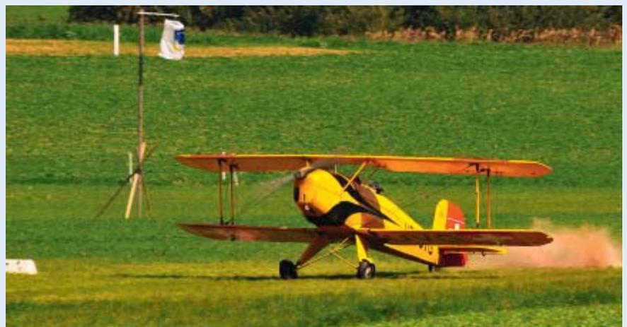
Die Bücker beim Aufsetzen. Heckrad-Fahrwerke (taildragger) eignen sich besonders gut zum Landen auf staubigen Graspisten, da der Propeller weiter vom Boden entfernt ist und weniger Dreck aufwirbelt. Früher waren die meisten Flieger so gebaut. Vorteile sind weniger Gewicht, weniger Luftwiderstand als Bugradfahrwerke. Nachteile: Diese Flieger sind anspruchsvoller zu landen. Die Sicht nach vorne ist ziemlich eingeschränkt. Quelle: Marcel Weber ([www.starflight.ch](http://www.starflight.ch))
